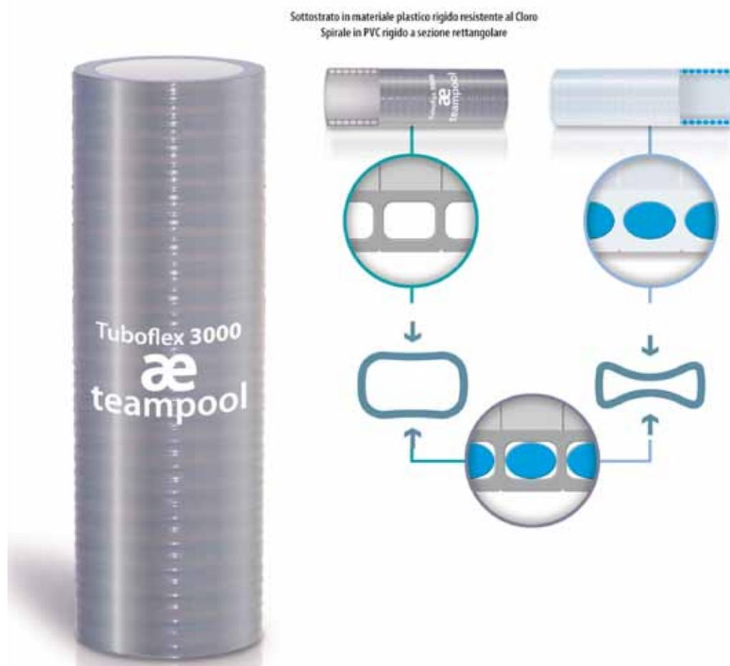
Il Sottostrato in Materiale Termoplastico rigido combinato con la Spirale in PVC rigido a sezione rettangolare garantiscono un incremento del 30% del PVC rigido a parità di spessore parete del tubo, che consente un più lento invecchiamento della spirale del tubo ed una resistenza alla compressione più alta del 50% rispetto ai tubi con spirale tonda o ovale, e più precisamente:
