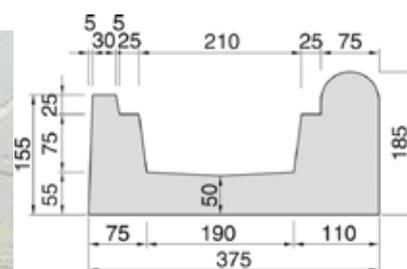
E' previsto per applicazioni con verniciatura, vetroresina e rivestimenti vari. Si può utilizzare nelle sue colorazioni naturali in abbinamento con vari tipi di rivestimento; funge così da cornice di fascia perimetrale interna. Se abbinato a piastrelle e mosaici vetrosi, spezza l'uniformità del rivestimento delle pareti e consente di realizzare progetti personalizzati in funzione della propria vena estetica.
